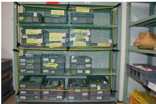
指定標本が設置されている収蔵庫内標本棚 (標本棚は床固定、地震時の飛び出し防止 ネットを設置)
