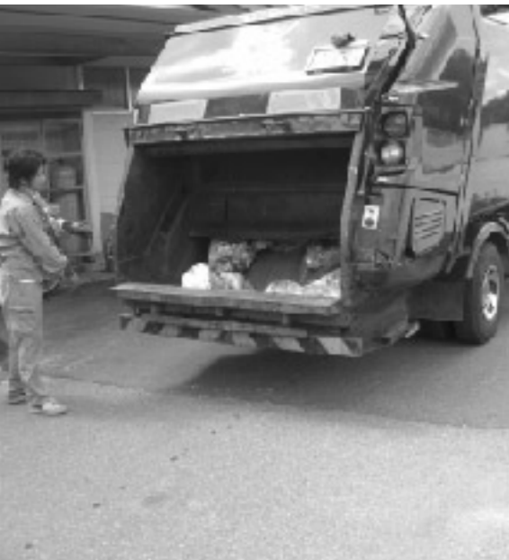
パッカー車によるゴミ回収
