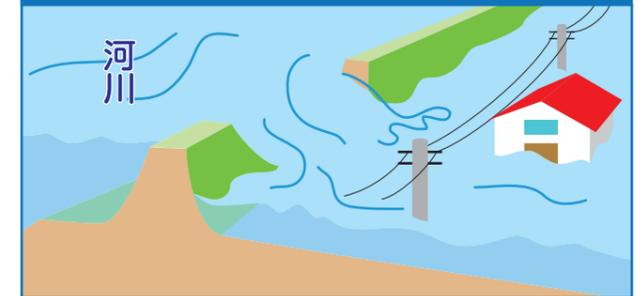
大雨によって河川を流れる水が大幅に増え、堤防から水があふれたり、堤防が決壊することにより水が流れ出す現象を「外水氾濫」と言います。
