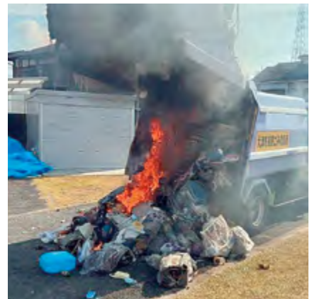
▲リチウム蓄電池混入による火災
