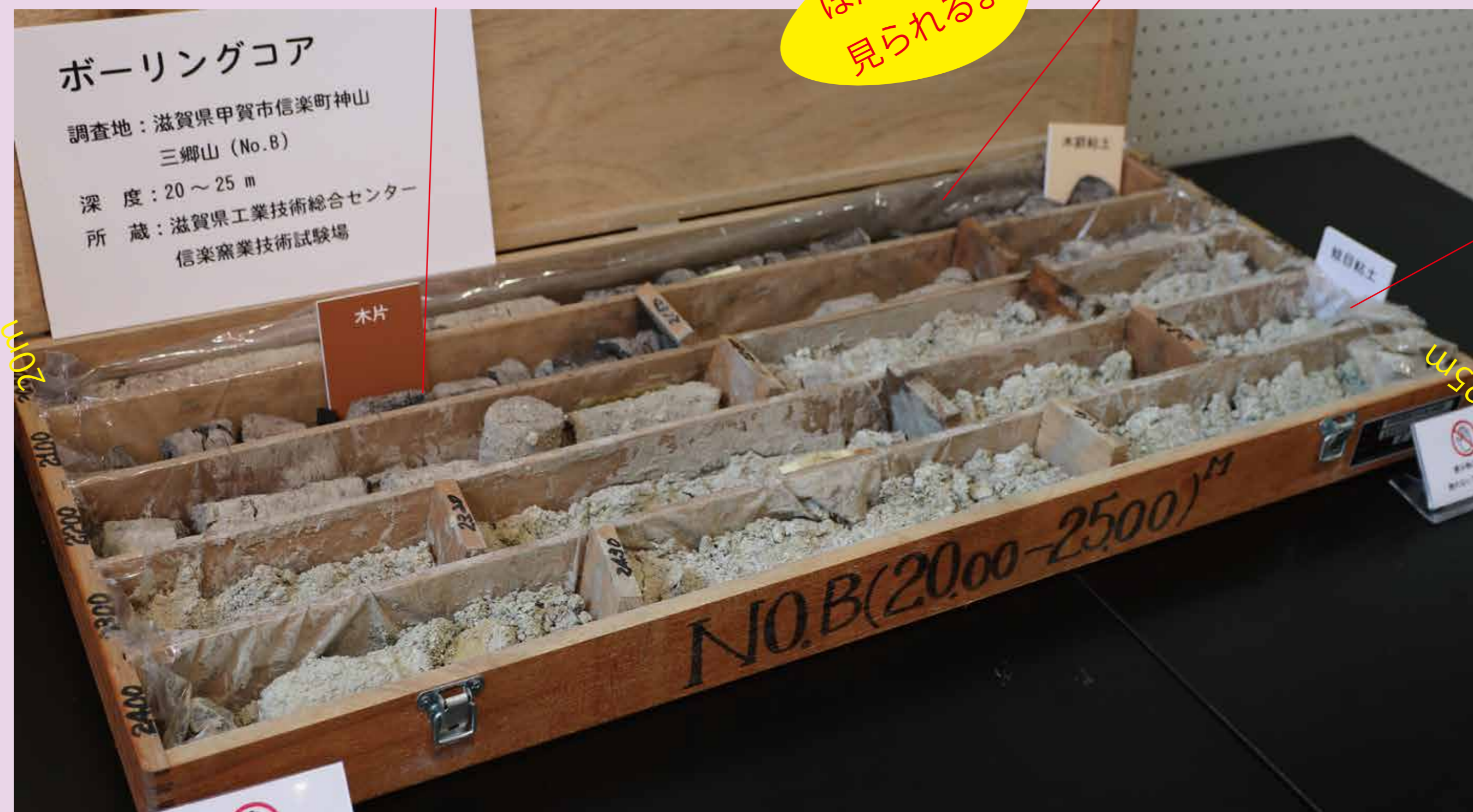
展示してある三郷山鉾山（信楽町神山）の陶土層 地下のボーリングで穴を掘ってコア（地層の円柱）を掘り上げたもの。箱に入ったコアの写真を深さにあわせてつないだら右のように地層の柱になります。
